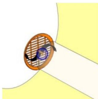
Pasul 2: Împingeți complet afară, rotiți sens antiorar pentru blocare
